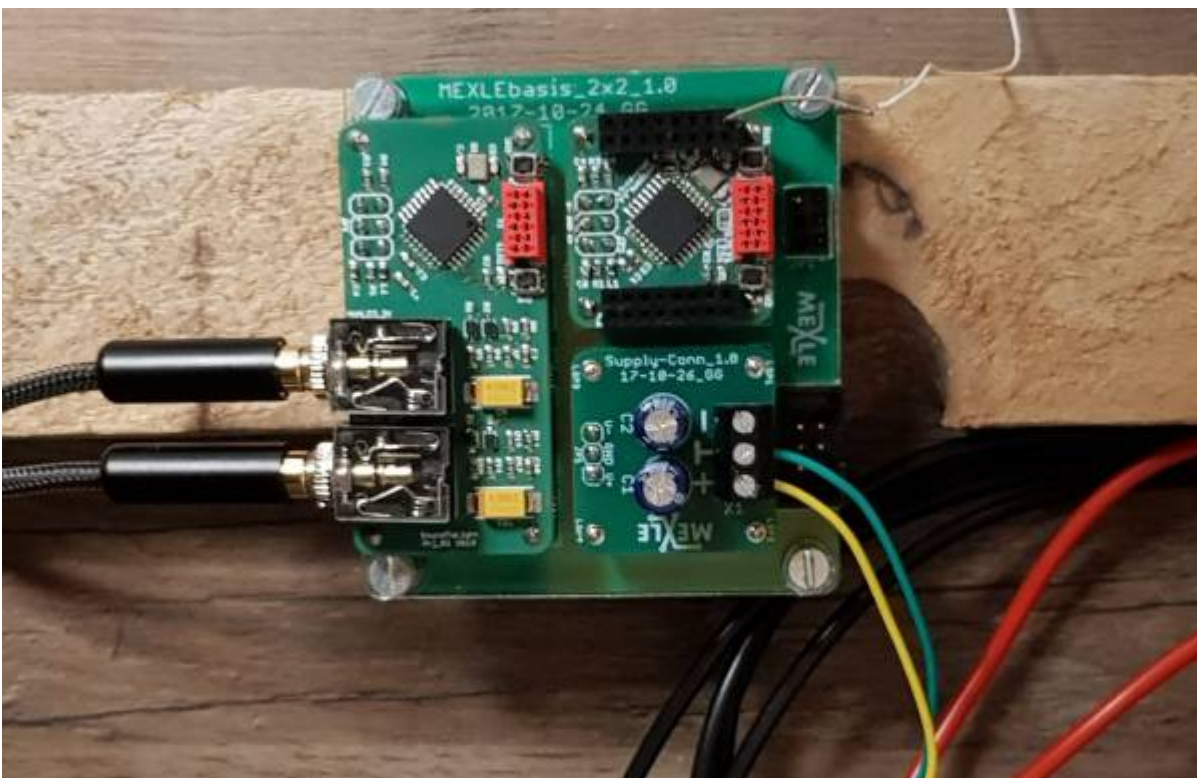
Elektronik des LED cube auf MEXLE2020 Basis (zwei ATmega328 zur Auswertung von
