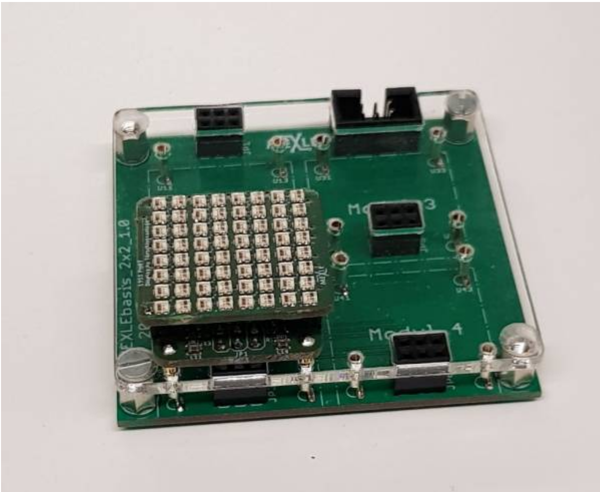
MEXLE Microcontroller Board mit selbst entwickeltem 8x8 Farb-LED Matrix (WS2812) auf 25x25mm 2
