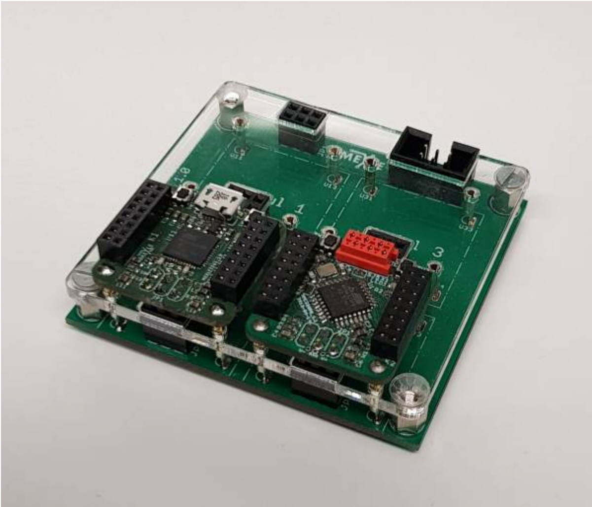
zwei MEXLE Microcontroller Boards: eines mit ATmega328, ein weiteres mit USB-Anschluss an ATmega32U4.
