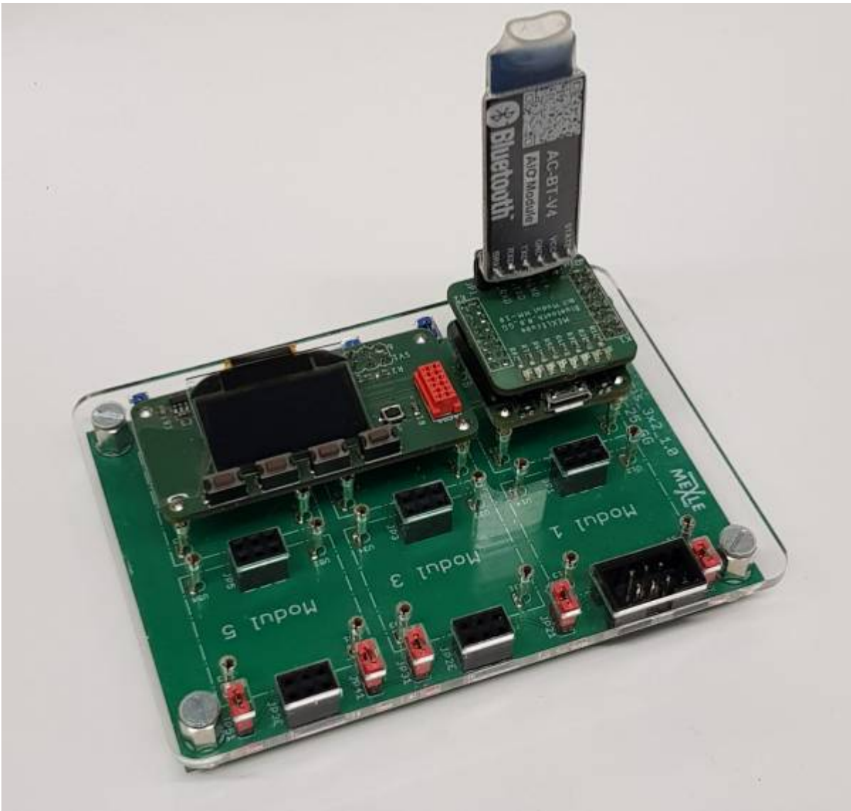
MEXLE Microcontroller Board mit Bluetooth-Dongle und Display/Tasten Board
